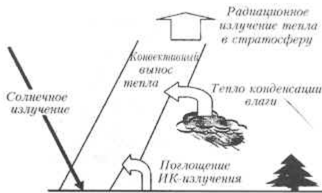
Рис. 5. Баланс средних теплотерь в тропосфере Земли: конвекция воздушных масс уносит около 67% приземного тепла, конденсация влаги добавляет 22%, поглощение тепла – 11%
